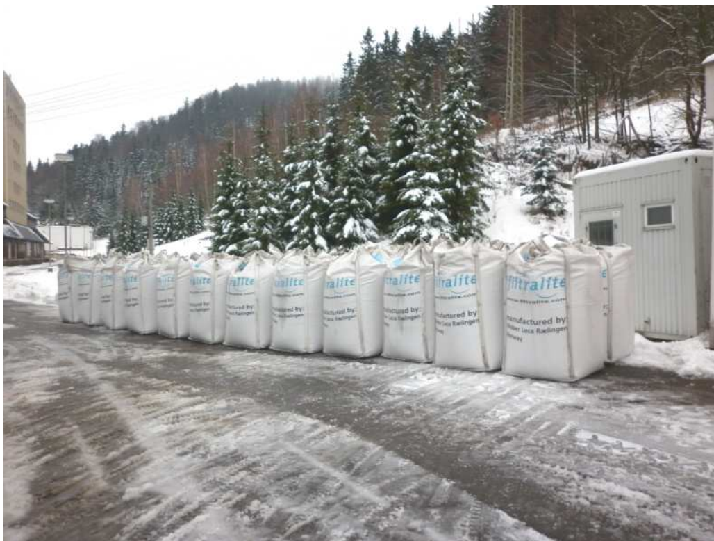
Obrázek 1. ÚV Bedřichov – filtrační náplň Filtralite
